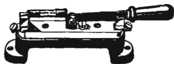
Fig. 6.11. - L'interruttore a coltello serve per mettere a terra l'antenna esterna in caso di perturbazioni atmosferiche. L'antenna va collegata alla precentrale, l'apparecchio all'estremità destra e la terra a quella sinistra.
