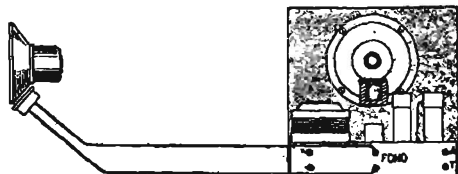
Fig. 7.23. - Come un altoparlante può sostituire il microfono.
