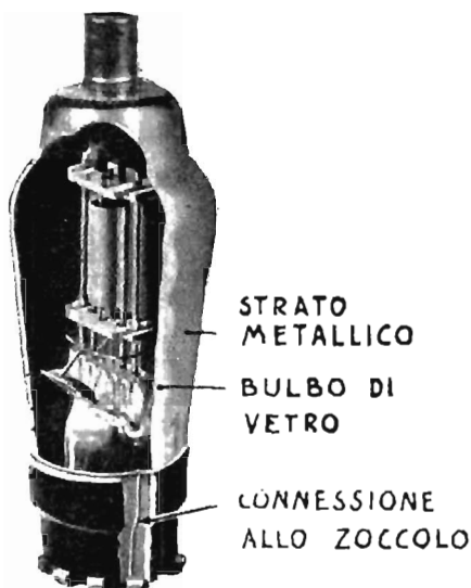
Fig. 5.8. - Lo strato metallico esterno di cui sono provviste alcune valvole moderne costituisce uno schermo di protezione contro azioni elettriche esterne. Le quattro prime valvole di fig. 5.10 sono di questo tipo.
