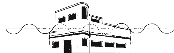
Fig. 1.4. -- Gli edifici sono quasi trasparenti rispetto alle onde radio. Fanno eccezione quelli in cemento armato.
